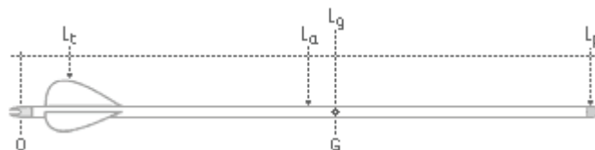
Fig.9 - Calcolo della posizione del baricentro
